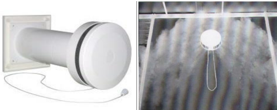
Joonis 3. Värskeõhuklapp ja sama klapi õhujuga laboritingimustes sise- ja välistemperatuuride erinevusel 30 °C ning õhuvooluhulgal 8 l/s
